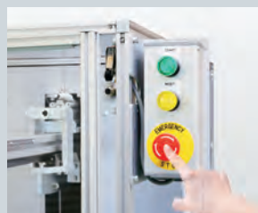
非常停止ボタン
